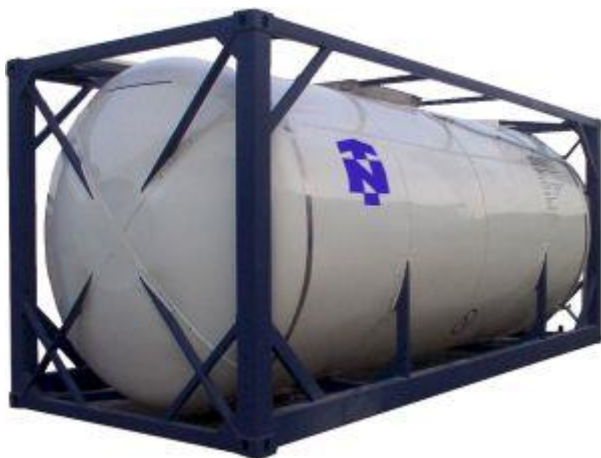
Мал.4. 20- і футовий контейнер типу «TANK CONTAINER».
