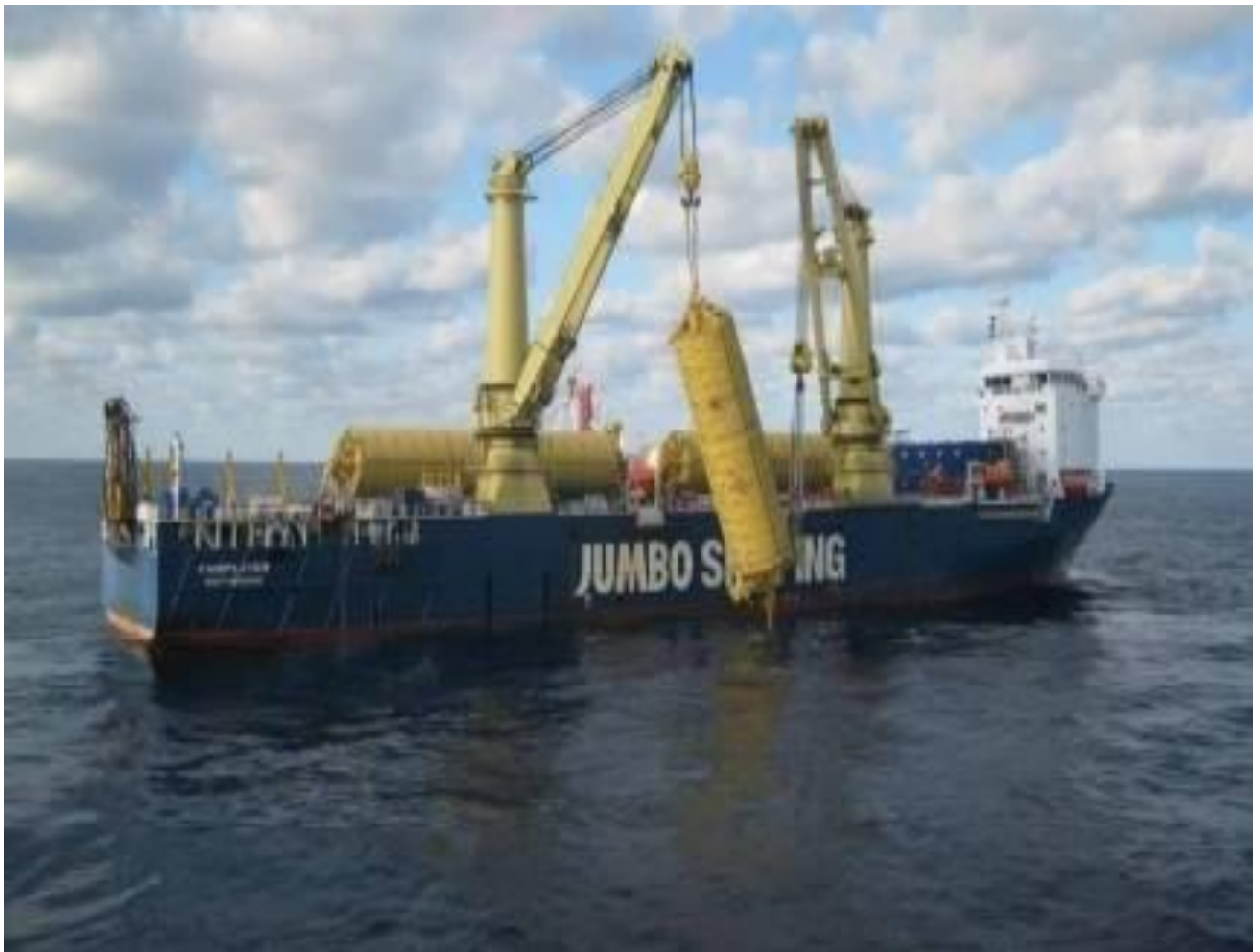
Мал.7. Судно компанії « Jumbo Shipping » завантажує на борт ректифікаційні колони вагою близько 750 тонн для нафтопереробного комплексу.
