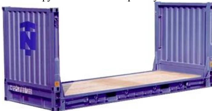
Мал.3. 20- і футовий контейнер типу «FLAT RACK CONTAINER».
