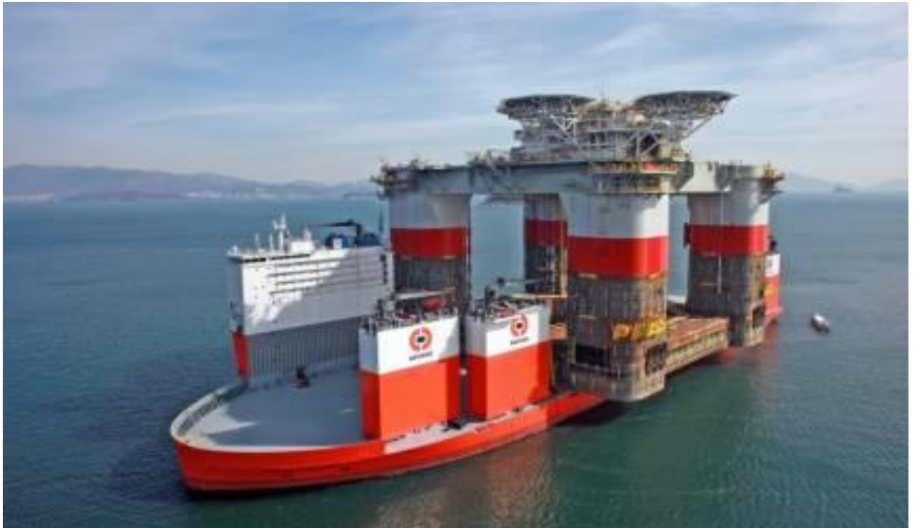
Мал.2. Dockwise Vanguard під час транспортування нафтової платформи.
