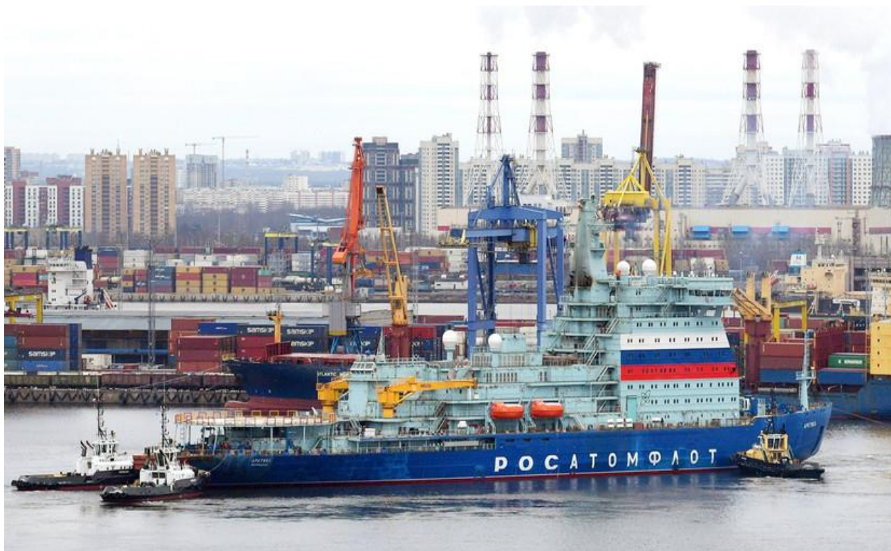
Мал.4. Найбільший і найпотужніший у світі криголам «Арктика». Криголами цього проекту здатні долати лід товщиною 2,8 метра.
