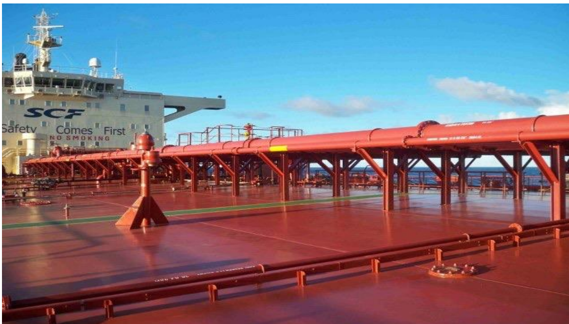
Мал.8. Трубопровід системи інертних газів на палубі танкера.
